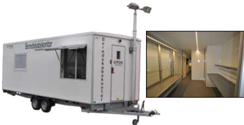
Vogn med kameraovervågning og kodelås på dør, udleveringsluger og teleskopmast
